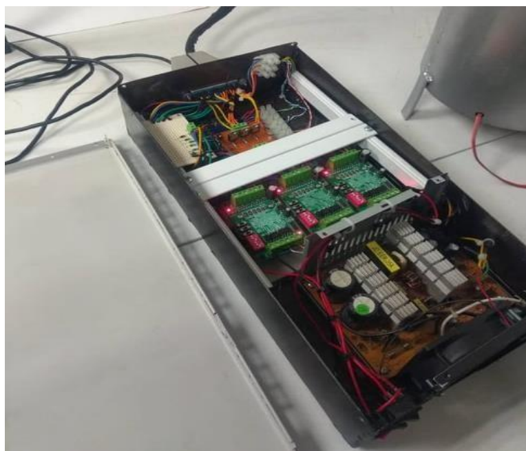
Figura 43. Se ilustra la caja de control con todos sus componentes soldados y ruteados.
