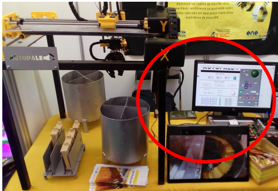
Figura 45. Se muestra el robot cartesiano completo donde se puede apreciar que es fácil desconectar el cable de conexión (robot-caja).
