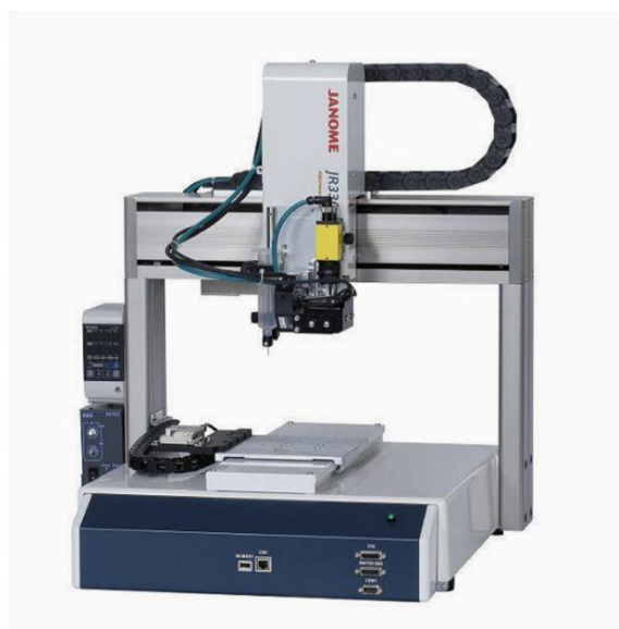
Figura 8. Robot Cartesiano, con aplicación a la industria eléctrica. 14
