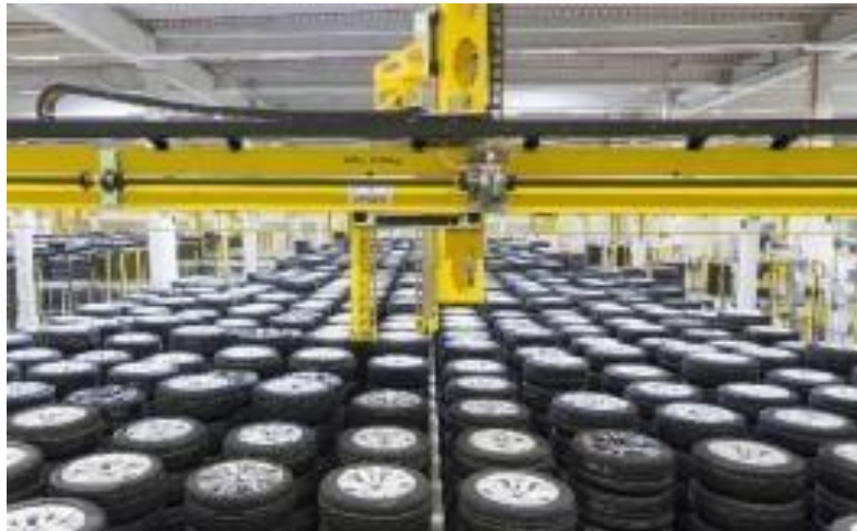
Figura 10. Robot Cartesiano, Aplicación industrial para el manejo de material. 17
