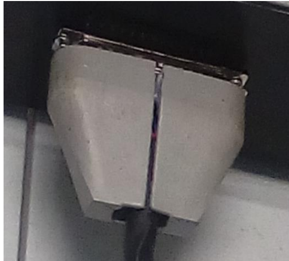
Figura 38. Ensamble de tapas de protección hembra y macho en conector tipo d de 47 pines
