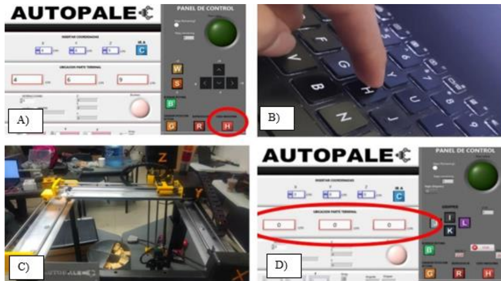
Figura 50. Se muestra A) el panel maestro, indicador “H”, B) el operador presionando la tecla “H”, C) El autómat yendo a su punto inicial y D) los indicadores de posición para cada eje.
