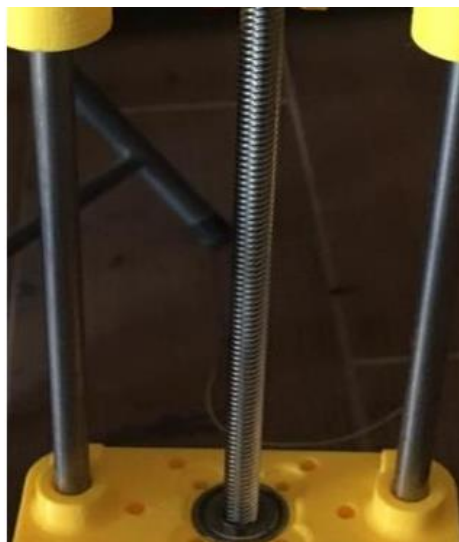
Figura 18. Husillo de 8mm de radio x 50cm empleado como transmisión mecánica en el robot cartesiano.
