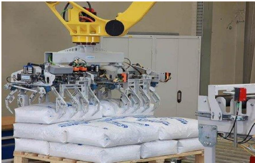
Figura 9. Robot Paletizador, Aplicación industrial. 16
