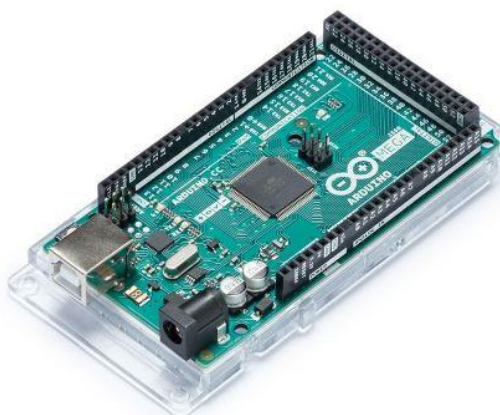
Figura 23. Placa electrónica basada en el microcontrolador ARDUINO ATmega2560. 23
