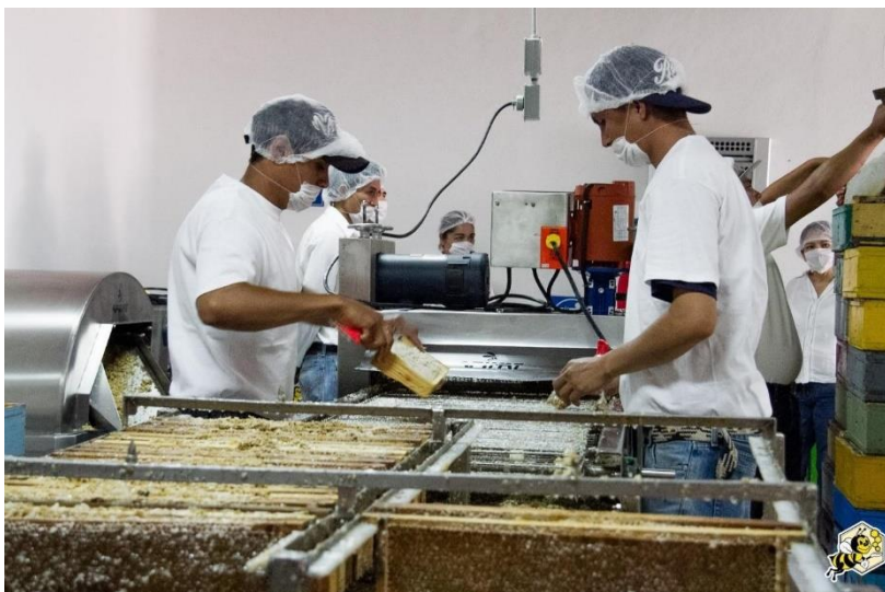
Figura 12. Proceso de perforado de bastidores para tener una mejor centrifugación. 21
